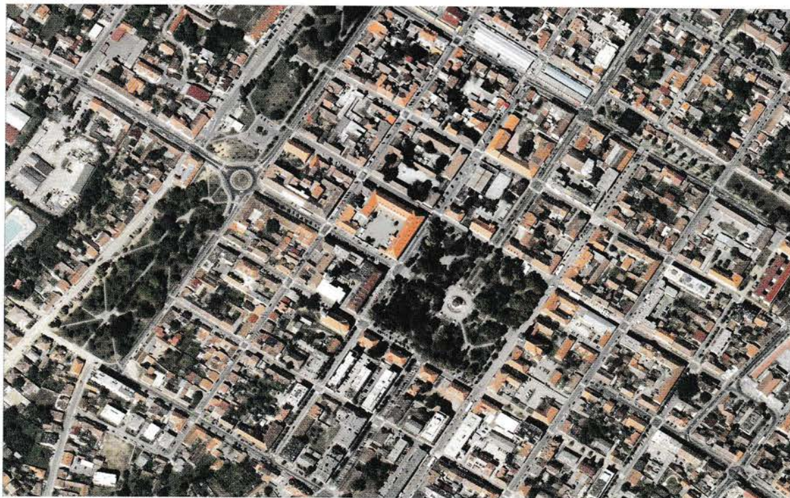
Slika 12. Digitalni ortofoto plan (DOF 2) nastao na temelju aerofotogrametrijskog snimanja 2008. godine u postupku Tehničke reambulacije za K.o. Bjelovar, K.o. Brezovac i k.o. Bjelovar-Sredice. Područni ured za katastar Bjelovar.
