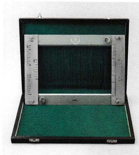
Slika 15. Nitni planimetar. Proizvođač „Geomehanika“ Zagreb. Područni ured za katastar Bjelovar.
