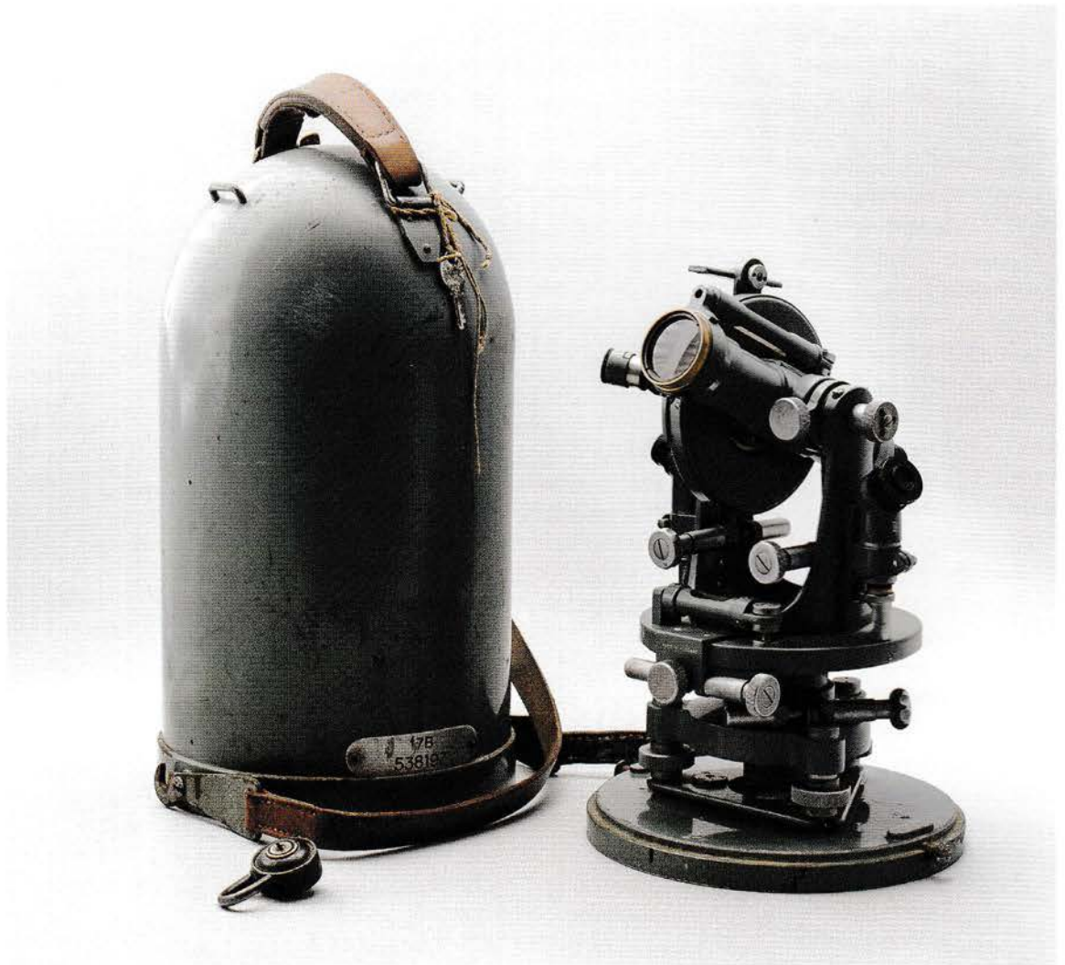
Slika 17. Optički teodolit. Područni ured za katastar Bjelovar.
